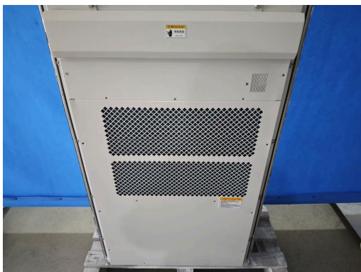
图 R01.6 测试后 室内侧无进尘（示意图-1）
