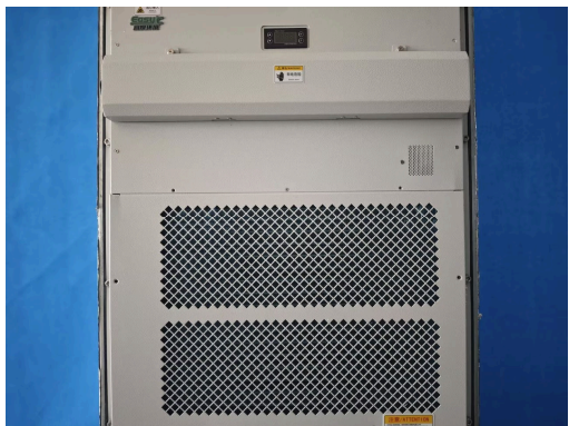
图 R02.8 测试后 室内侧无进水 (示意图-2)
