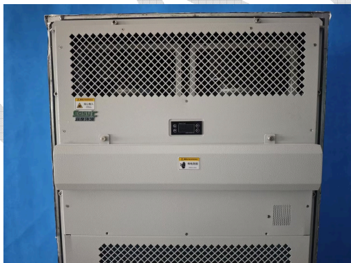
图 R02.7 测试后 室内侧无进水 (示意图-1)
